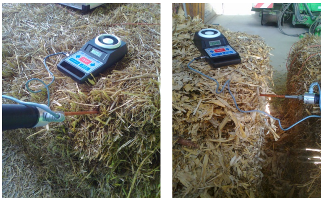
Obrázok 2 Vlhkomer AGRICOMPUTER CZ931 s meracou sondou pri meraní vlhkosti pšeničnej slamy a kukuričného kôrovia.
