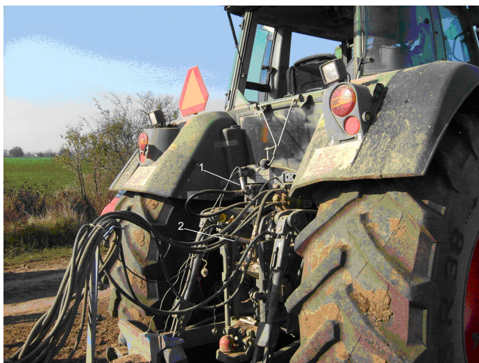
Obrázok 2. Umiestnenie tlakového a teplotného senzora vo vonkajších vývodoch hydrauliky (1 – teplotný senzor, 2 – tlakový senzor)
