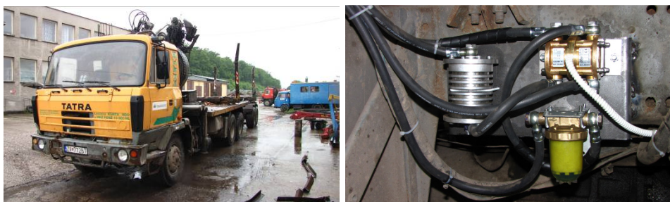
Obrázok 1 Snímač EPV 2.2 inštalovaný na TATRE T815 (vlastné foto)
