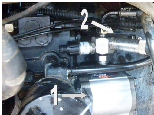
Obrázok 2 Umiestnenie snímačov tlaku a teploty na výstupe hydrogenerátora: 1 – snímač tlaku, 2 – zubový hydrogenerátor typu UD 25
