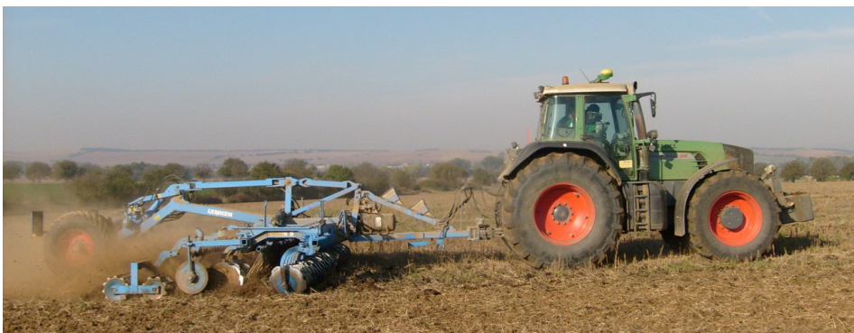
Obrázok 1. Traktor Fendt 926 Vario v súprave s diskový kypričom Lemken Rubin 9
