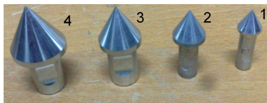
Obrázok 7 Skúšobne telieska penetrometra
