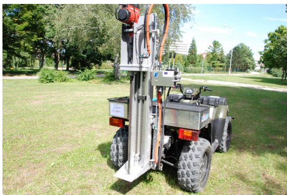
Obr. 2 A. Zariadenie na odobranie pôdnych vzoriek NH 90. B. Spôsob merania rozmerových charakteristík zŕn: 1 – indukčný snímač, 2 – zrno, 3 – podložka, 4 – laboratórny kovový držiak Fig. 2 A. Soil measurement equipment NH-90. B. Technique of measurement of grains' dimensional characteristics: 1 – induction sensor, 2 – grain, 3 – rest, 4 – laboratory metal holder
