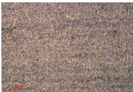
Obr. 12 Mikroštruktúra ocele K455 po tepelnom spracovaní 1. variant – zv.100x
