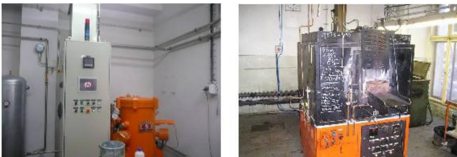
Obr. 8 Vákuová kaliaca pec a pôvodná kaliaca pec s atmosférou dusíka (Mincovňa kremnica š. p.)
