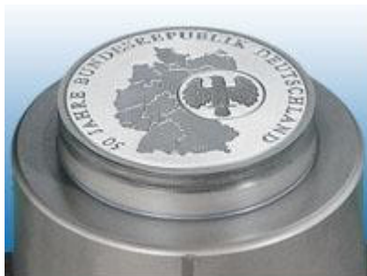
Obr. 2 Jedna časť párového nástroja pre razenie mincí
