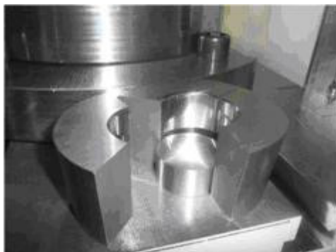
Obr. 7 Delené puzdro s polotovarom pred tvárnením reliéfu v lise (Mincovňa kremnica š. p.)
