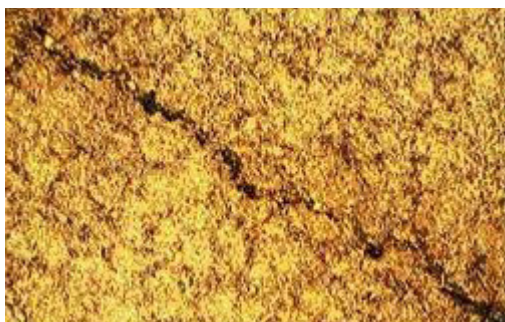
Obr. 5 Mikroštruktúra razidla po tepelnom spracovaní
