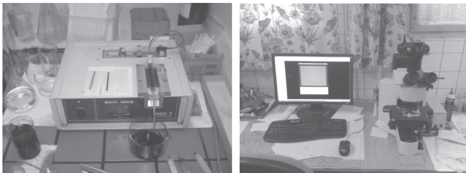
Obrázok 5 Príprava ferogramu a jeho vyhodnotenie
