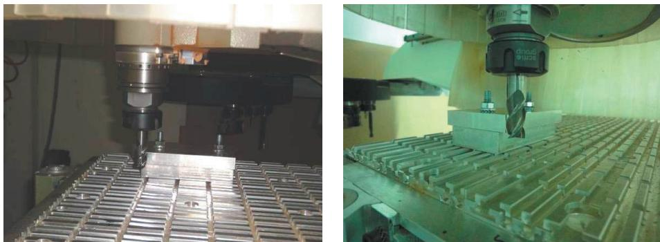
Obrázok 3 Upnutie a frézovanie vzorky
