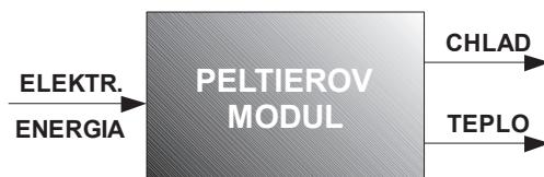
Obrázok 4 Energetická schéma Peltierovho modulu
