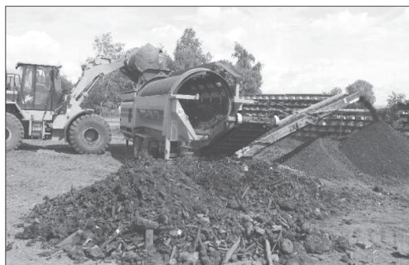
**Obr. 4** Prosévání výsledného kompostu pomocí bubnového třídiče
