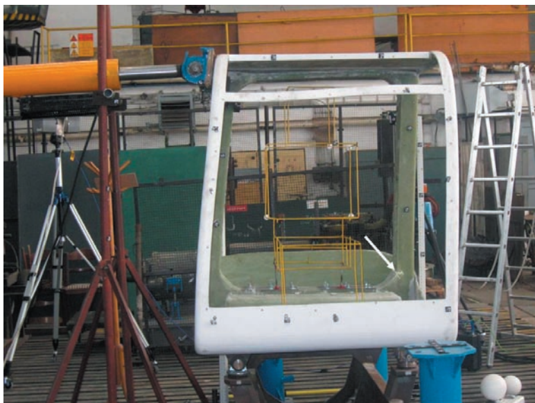
Obrázok 5 Skúšobná zostava pri bočnom zat'azení laminátovej kabíny
