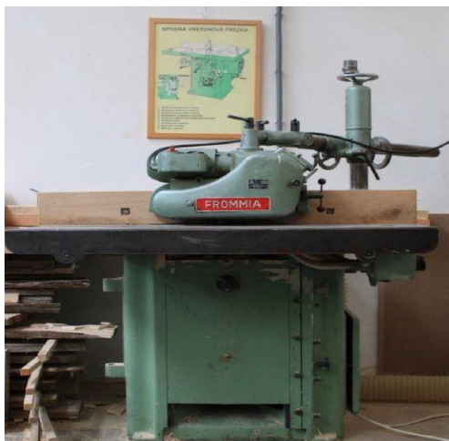
Fig. 5 Lower spindle milling machine FVS and feeder mechanism Frommia ZMD 252/137 Obr. 5 Spodná vretenová frézka FVS s podávacím zariadením Frommia ZMD 252/137
