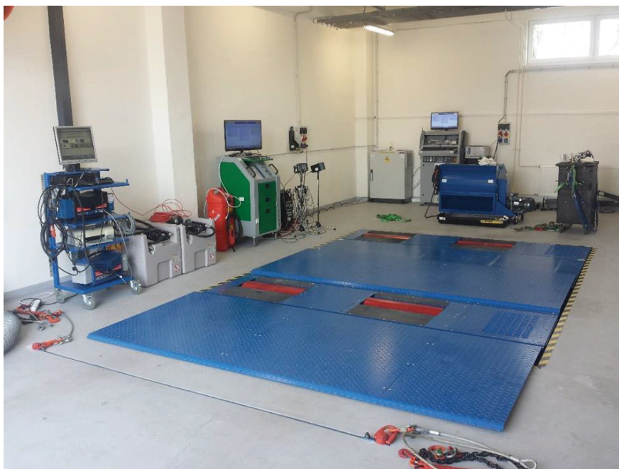
Fig. 2 Cylinder test unit MAHA MSR 500 Obr. 2 Valcová výkonová skúšobňa MAHA MSR 500
